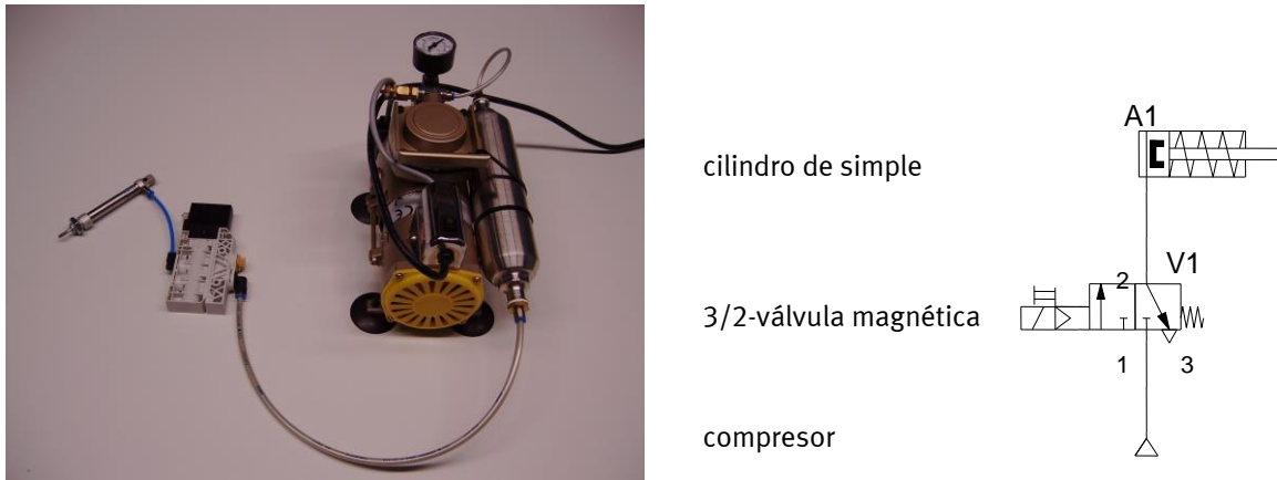
Figura 1.4: Componentes reales representados en el esquema neumático
