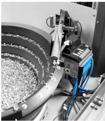
Figura 4.1: Espiral de avance por vibración para almacenar y clasificar tornillos
